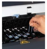
Die Druckköpfe können vom Anwender selbst gewechselt werden, sodass Ausfallzeiten minimiert werden.
