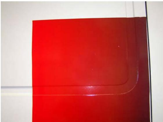
Drücken Sie die Folie mit einem Finger (Baumwollhandschuhe tragen!) oder unter Verwendung des 3M Roller L in die Mitte der Vertiefung.
