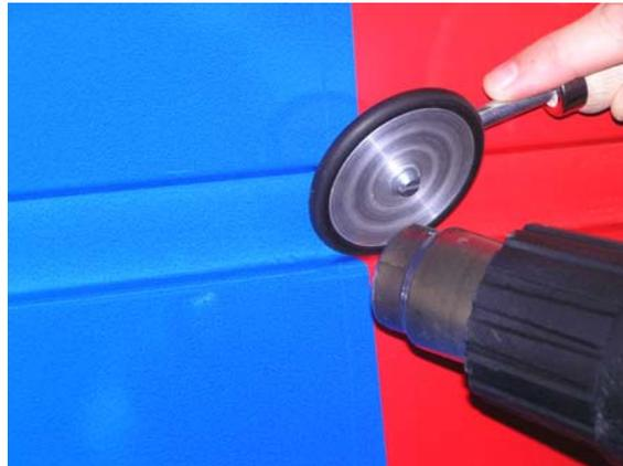
*Hinweis: Bei Temperaturen knapp über 120°C kann die Folie kleine Bläschen an der Oberfläche werfen. Diese sind kein Zeichen von Lufteinschlüssen sondern entstehen durch Überhitzung der Folie. Regeln Sie die Temperatur etwas zurück, um ein Verbrennen der Folie zu verhindern.*
