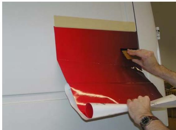
Vertiefungen und Sicken überspannen Sie einfach mit der Folie. Diese werden erst im nächsten Schritt in die Vertiefungen eingearbeitet.
