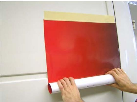
Entfernen Sie vorsichtig das Schutzpapier von der Folienrückseite, um den Klebstoff freizulegen.
