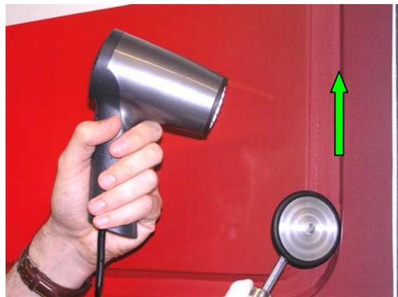
Stechen Sie eventuelle Luftpneinschlüsse mit der 3M Verklebenadel „Air Release Tool“ auf und rollen Sie die Folie erneut an.
